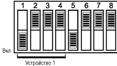
Рис. 1. Установка DIP-переключателей для отдельного устройства
